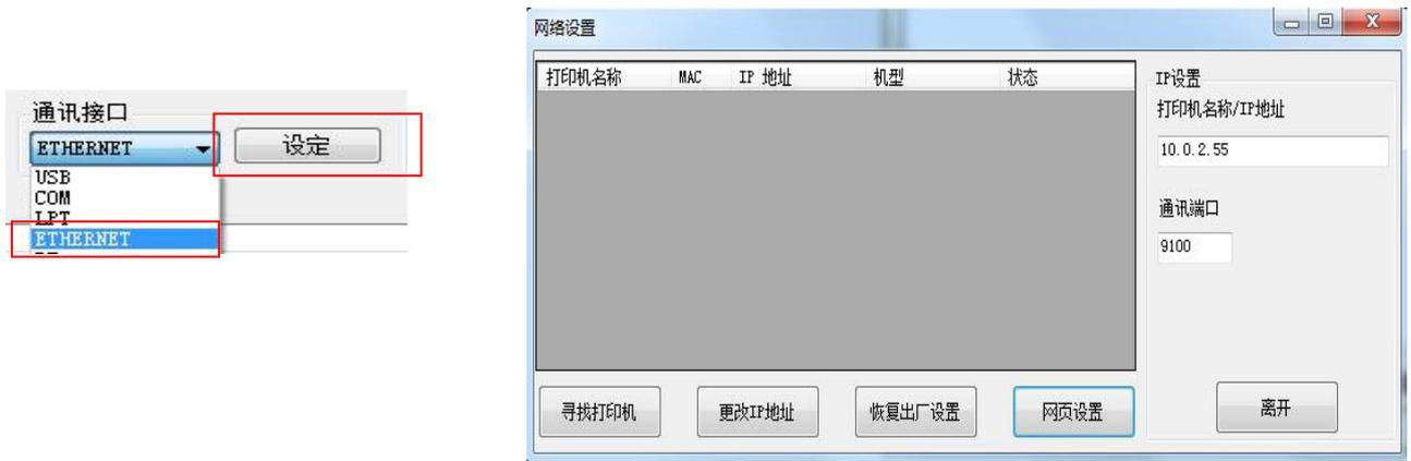
5. 按下“寻找打印机”键可寻找有在局域网络上的打印机。
