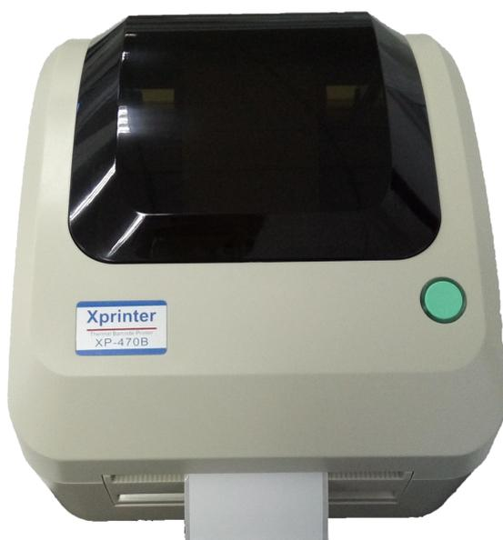
注意: 为避免打印质量不良, 请确实将打印机上盖关紧。
