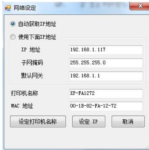
此 IP 设定的出厂默认值为”自动取得 IP 位置”。如需改变 IP 位置请选择”指定 IP 位置”并输入欲设定的 IP，子网掩码和通信闸，之后按下”设定 IP”键设定用户也可于此处改变打印机名称，于打印机名称处输入欲改变的名称之后按下”设定打印机名称”即可
